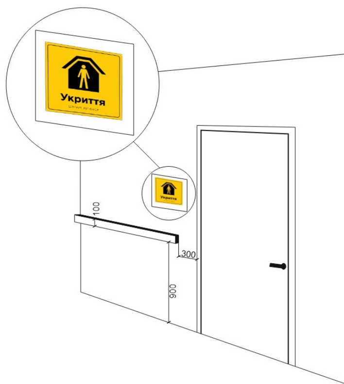
Рисунок 22 – Приклад розміщення тактильних інформаційних показників споруд ЦЗ: 1 – інформаційна направляюча; 2 – тактильна інформаційна позначка; 3 – інформаційна тактильна табличка, що дублює текстову інформацію у тактильному вигляді плоско друкованого тексту та шрифтом Брайля
